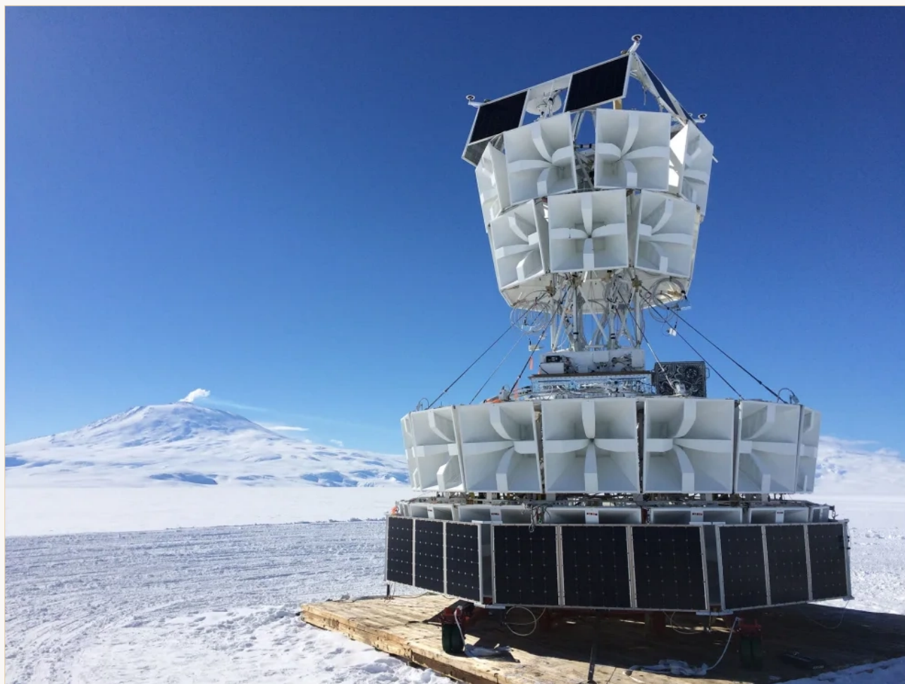
ANITA の 48 基のアンテナは、高さ 25 フィートのゴンドラから南極の水床へ向けられている。
